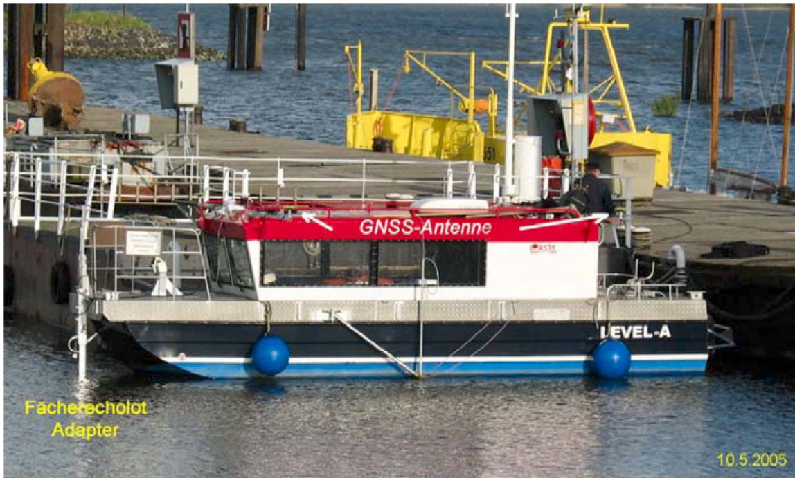
Abbildung 5: Messschiff LEVEL-A des Department Geomatik, HCU (Andree 2005).
