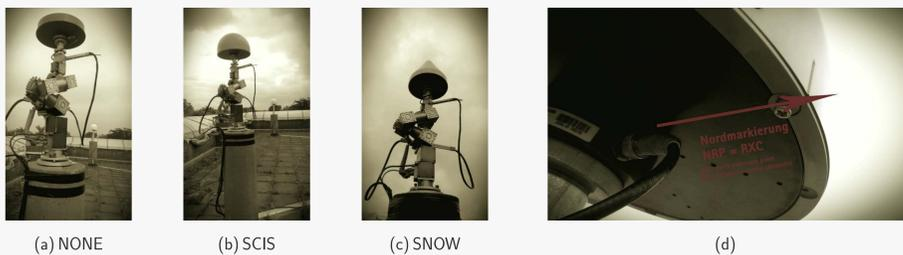
Fig. 2: Kalibrierung der Antenne in 3 Kombinationen (a-c) und Nordmarkierung der Antenne sowie Serienetikett (d).
