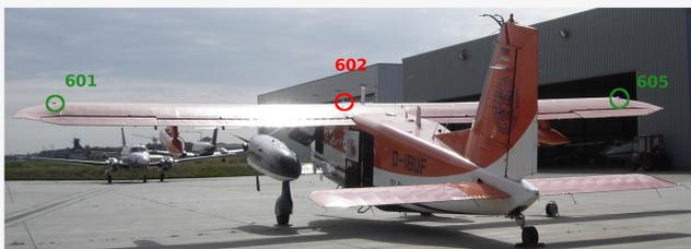
Abb. 5: Forschungsflugzeug Do 128-6 D-IBUF des Institut für Flugführung (IFF) der TU Braunschweig mit Antennenpositionen und -bezeichnungen.
